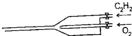
Obr. 2.2. 8.3 Schematické znázornenie princípu injektorového horáka
