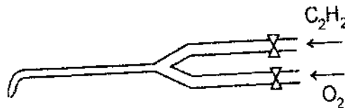
Obr. 2.2. 8.4 Schematické znázornenie princípu injektorového horáka
